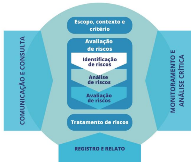
Figura 2 - Processo de gestão de riscos conforme a norma ABNT NBR ISO 31000:2018
